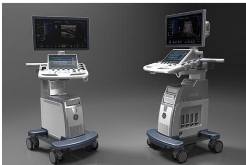
「LOGIQ P9」と「LOGIQ P7」は、大型ワイドモニター、タッチパネル、移動後も速やかに操作を開始できる電源装置「Mobile Assistant」\*2を搭載(「Mobile Assistant」は「LOGIQ P9」のみ)しており、操作中の技師のストレスの軽減を図っています。さらに、操作に対する疑問やトラブルに迅速に対応するために、技師自身が瞬時に操作方法を確認できる取扱い説明動画「マイトレーナー」を搭載しており、技師の検査効率の向上にも貢献している製品です。また、超音波検査の幅の広がりや、患者の高齢化に伴い増加している検査数に対応するため、運搬しやすいコンパクトサイズで 60kg というクラス最軽量\*3を実現しており、検査技師の約 7 割を占める女性技師\*4にとって使いやすい軽量装置となっています。
