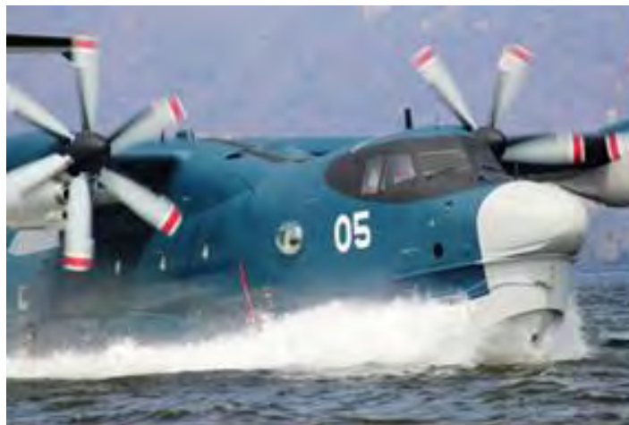
海上自衛隊に配備されているダウティ・プロペラズ製「R414」プロペラシステムを搭載した 新明和工業製「US-2 型救難飛行艇」（写真提供：新明和工業）
