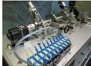
50 年以上にわたる機械保護と状態監視装置のリーダーとして活躍するベントリー・ネバダ。産業用モータ、発電タービン、コンプレッサ等、さまざまな回転機器から発生する振動を最新システムでシミュレーションします。
