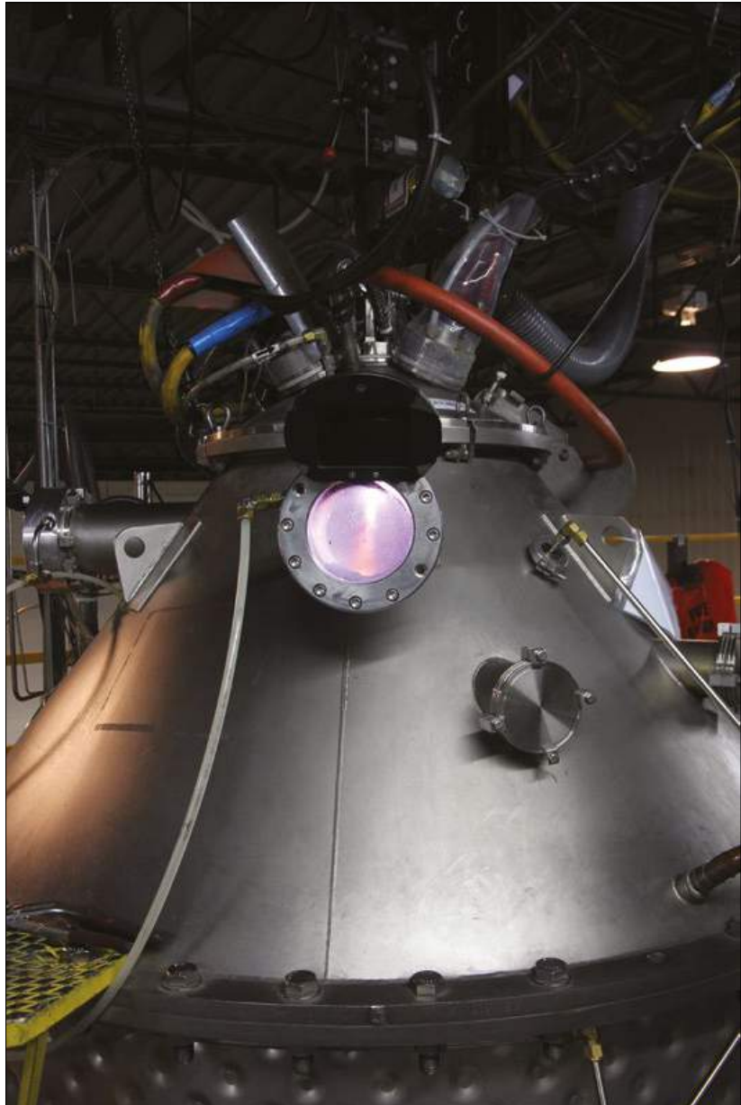
Fig. 3 A plasma atomisation production unit
